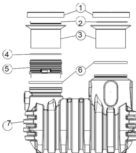
Beim SUF 7-700 / SUF 15-1500 / SUF 15-1500-Tank sind keine weiteren Zwischenstücke (5) möglich.
