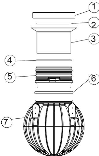
Beim SUF 2-200-2 / SUF 4-500 -Tank kann das Zwischenstück (5) 300 oder 500er mit entsprechender Dichtung verbaut werden.
